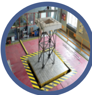
IS. SISMIC Simulador sísmico con seis grados de libertad.
