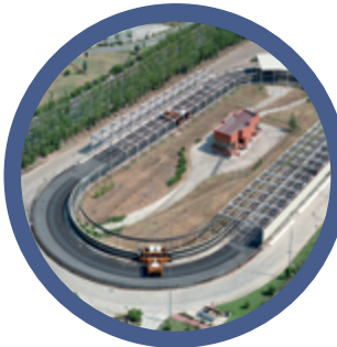
IS. PISTA Pista de ensayos acelerados de firmes a escala real.
