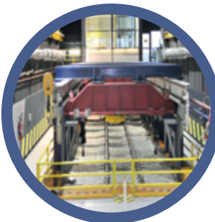
IS. CAJÓN Cajón Ferroviario, célula de grandes dimensiones para ensayos de secciones ferroviarias.
