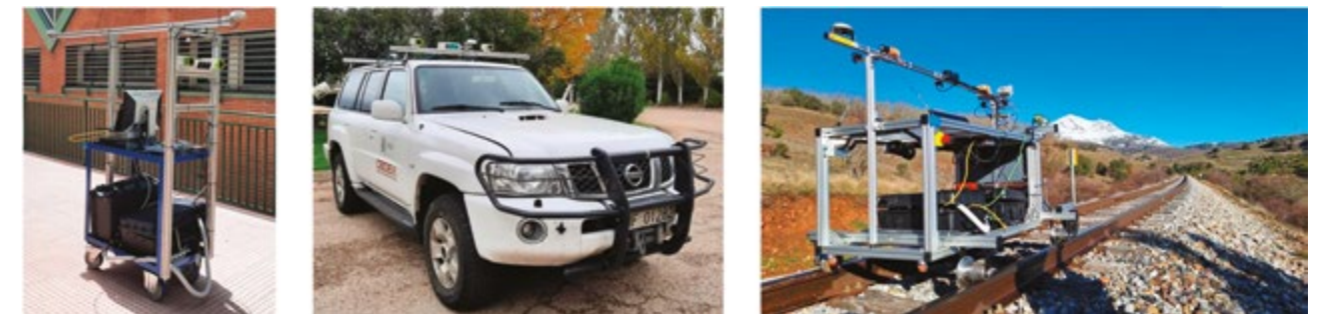
Arquitectura del sistema montada en diferentes plataformas: carro del laboratorio, coche del IRTER y carro de vía
