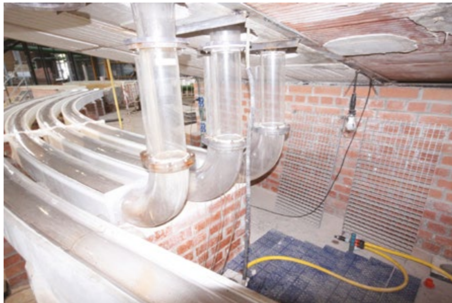
Vistas de la embocadura y los túneles incluidos en el modelo físico
