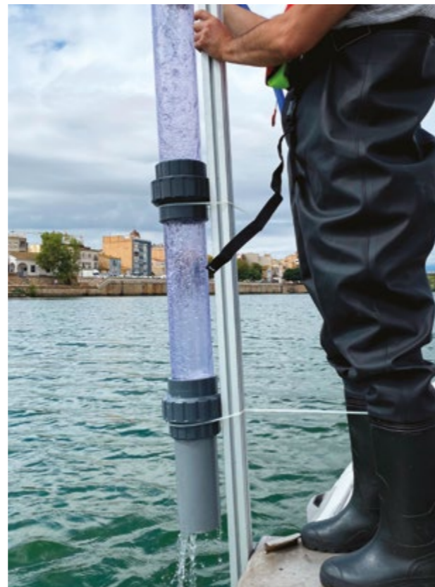
Sistema de bombeo con columna de filtración diseñado en el CEDEX para el muestreo de microplásticos en la columna de agua
