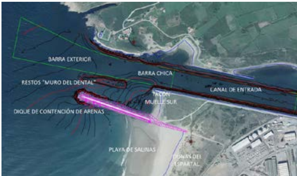
Elementos principales del sistema litoral de la desembocadura de la ría de Avilés y la playa de Salinas/Espartal
