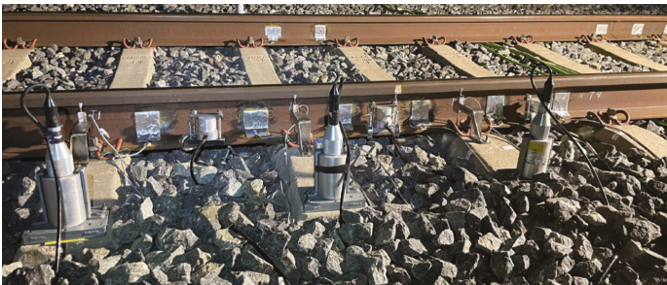
Sección experimental instrumentada en la LAV Madrid-Barcelona P.K. 91+500
