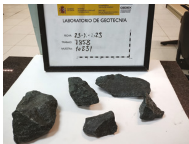
Fotografía de las partículas que componen el material granular lavadas para ver adecuadamente su superficie
