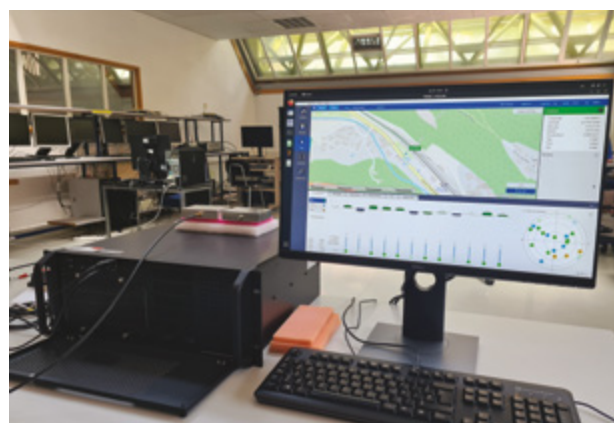
Simulador de señales satelitales integrado en el Laboratorio de Simulación de Tráfico del LIF
