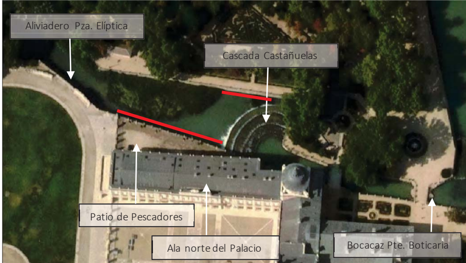
Figura 3. Vista aérea del área de estudio. Los tramos de muro afectados por socavación en su base aparecen señalados en rojo. Elaboración propia a partir de la ortofotografía de máxima actualidad del PNOA, extraída del IGN.
