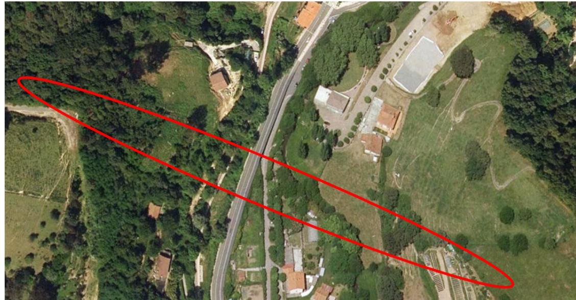
El trazado en planta en el tramo de cruce describe una curva a derechas (PK crecientes) que en el tramo en superficie desarrolla una clotoide de parámetro 1.000 de transición al radio 5.000 m que se desarrolla en el siguiente túnel.
