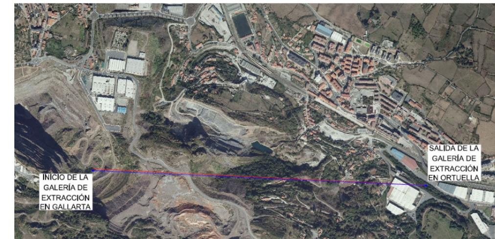
Se trata de una galería de extracción minera que se utiliza actualmente para la extracción de agua de las minas a cielo abierto hasta el Río Granada en Ortuella. La galería condiciona el trazado en alzado de los ramales de conexión, dificultando encajar un perfil sin puntos bajos intermedios que impliquen la disposición de bombes en el interior de los ramales.
