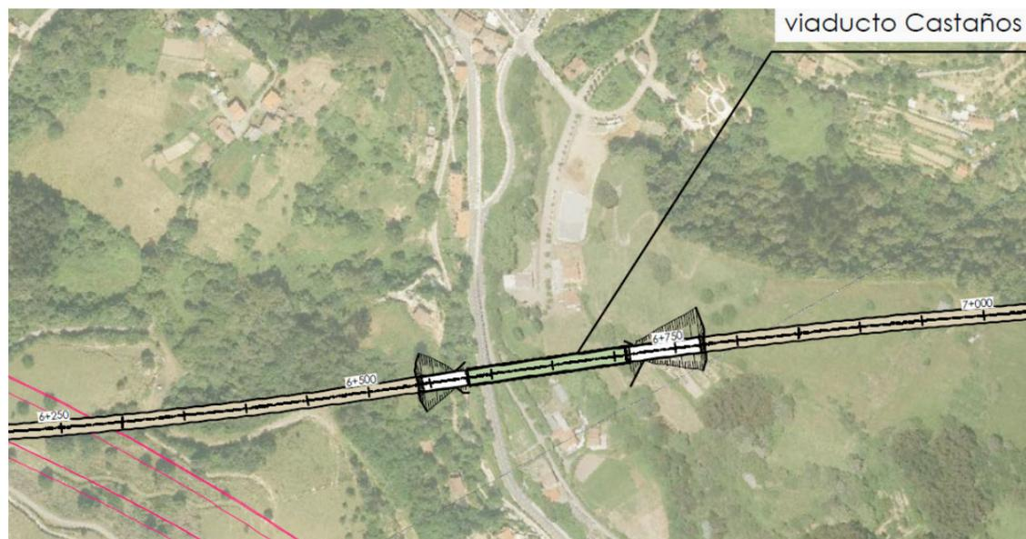
Por lo que se refiere al trazado en alzado, cuenta con un punto bajo en el emboquille de la ladera oeste ascendiendo a partir de ahí con una pendiente de 5 milésimas en todo el tramo. La longitud resultante para el viaducto ronda los 130 m y, además del cauce del citado río, la nueva estructura proyectada debe salvar un bidegorri, la carretera BI-4743 que da acceso al Barrio del Regato y un camino vecinal de acceso a fincas.
