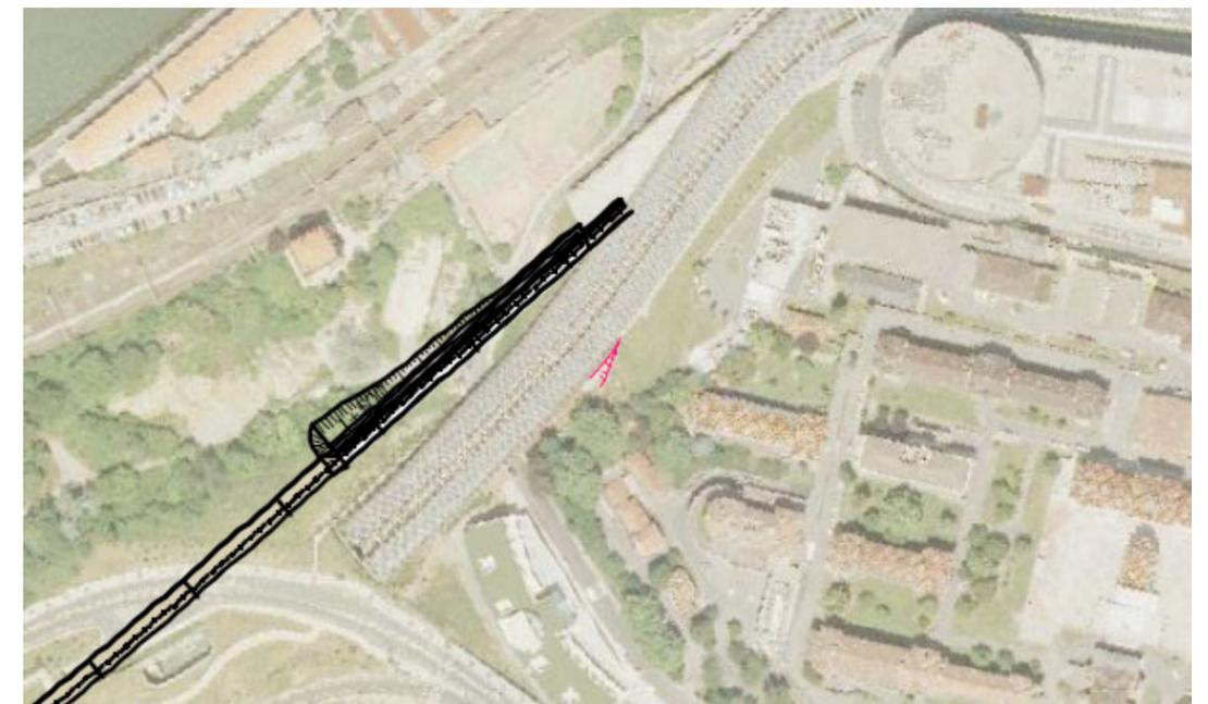
La actuación diseñada implica una interferencia del trazado con el vial de la cuesta de Olabeaga, al resultar incompatible la rasante de éste con la conexión con el cajón ya ejecutado. El motivo es que como se puede observar en la imagen, la vía proyectada para el tráfico de mercancías sale a la misma cota que el vial por
