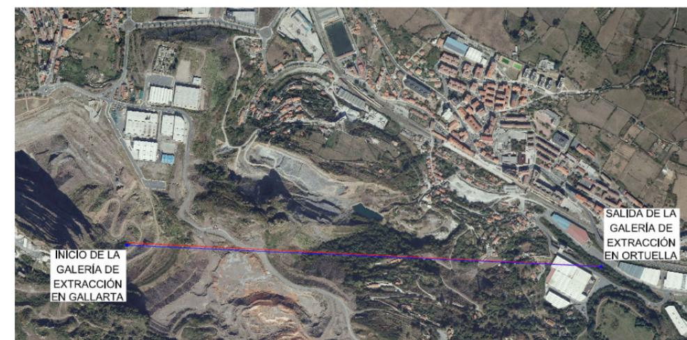
Se trata de una galería de extracción minera que se utiliza actualmente para la extracción de agua de las minas a cielo abierto hasta el Río Granada en Ortuella. La galería condiciona el trazado en alzado de los ramales de conexión, dificultando encajar un perfil sin puntos bajos intermedios que impliquen la disposición de bombes en el interior de los ramales.
