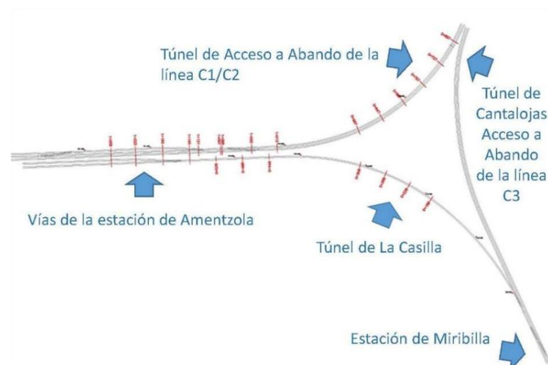
Partiendo de las bases de la red previamente implantadas y observadas, como ya se ha descrito, se han tomado secciones transversales cada 20 metros de cada uno de los túneles, con el fin de parametrizar la geometría interior del túnel tanto en su componente vertical como horizontal, además de conocer la geometría de la vía, la banqueta de balasto, y los elementos existentes, como canaletas y paseos existentes.
