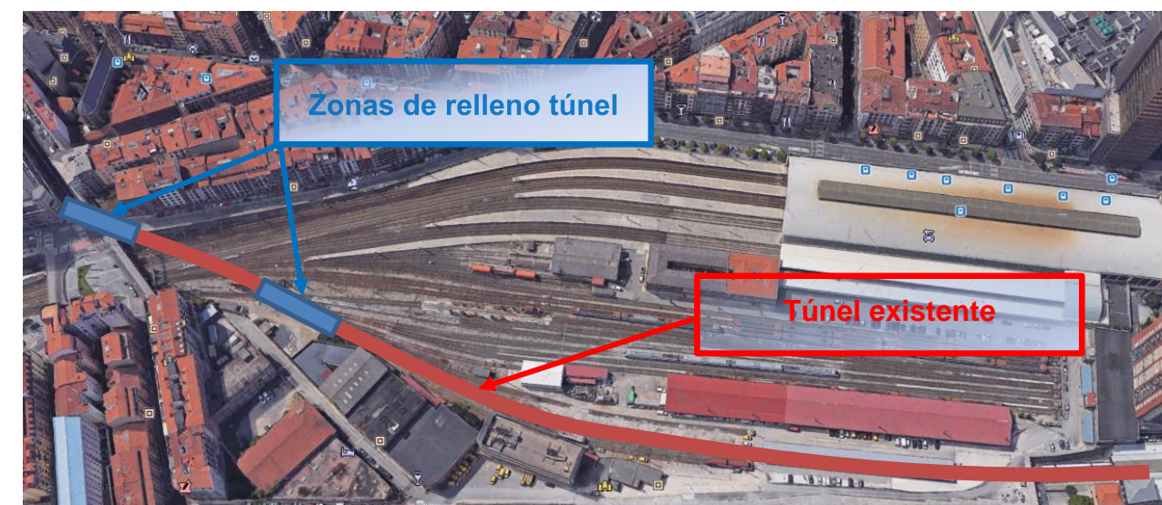
Túnel actualmente existente para vías de ancho métrico
