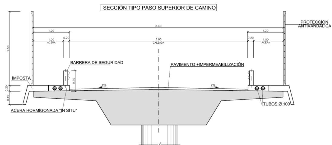
Para los pasos superiores de carreteras se diseña una sección con un ancho total de 12,4 metros que contendrá una calzada de 7,0 metros, dos arcenes de 1,0 m, dos aceras de 1,2 metros y dos pretilos de 0,5 metros cada una.
