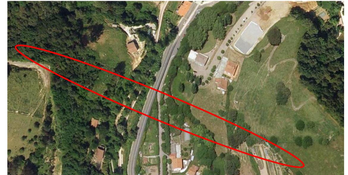
El trazado en planta en el tramo de cruce describe una curva a derechas (PK crecientes) que en el tramo en superficie desarrolla una clotoide de parámetro 1.000 de transición al radio 5.000 m que se desarrolla en el siguiente túnel.
