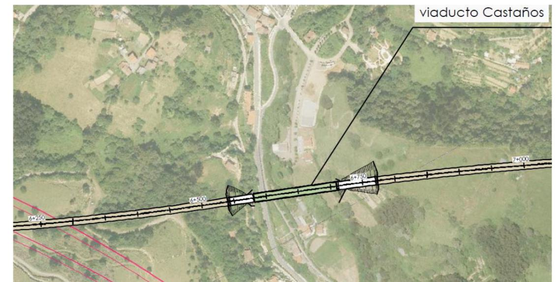
Por lo que se refiere al trazado en alzado, cuenta con un punto bajo en el emboquille de la ladera oeste ascendiendo a partir de ahí con una pendiente de 5 milésimas en todo el tramo. La longitud resultante para el viaducto ronda los 130 m y, además del cauce del citado río, la nueva estructura proyectada debe salvar un bidegorri, la carretera BI-4743 que da acceso al Barrio del Regato y un camino vecinal de acceso a fincas.
