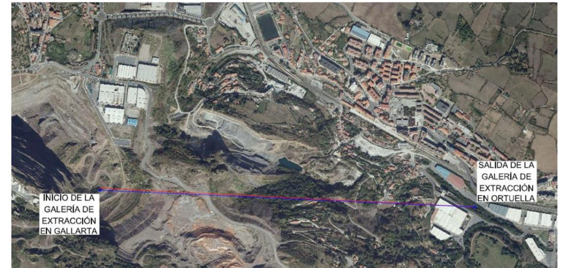
Como se aprecia en los siguientes detalles obtenidos de los planos de planta y perfil longitudinal del Ramal Serantes-Tronco, el cruce de la galería con el nuevo trazado se produce coincidiendo en planta con la sección previa a la separación de las vías, que pasan de discurrir en doble vía a túneles independientes de vía única para cada sentido. Siendo la diferencia de cota entre la clave del túnel y la solera de la galería de unos 7 metros en ese punto.
