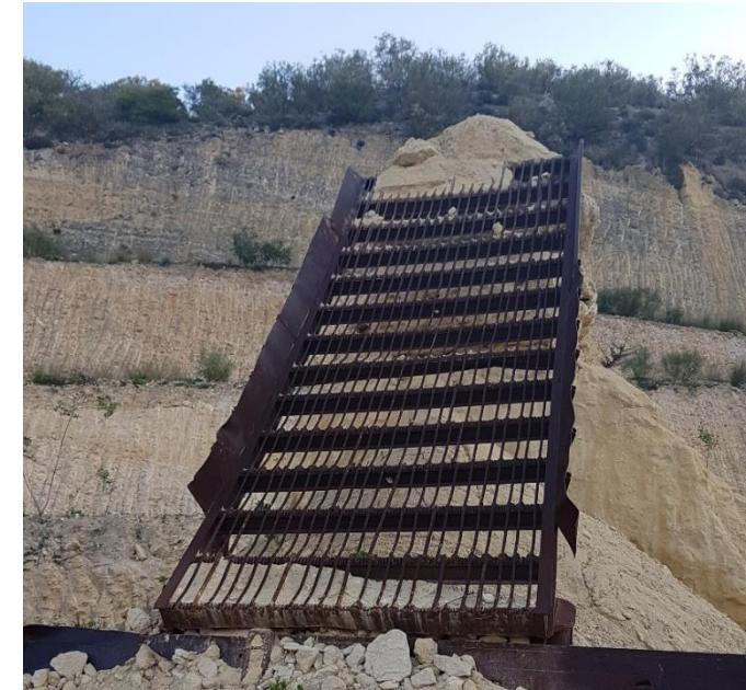
Imagen 17. Cantera San Kristóbal. Criba para Suelo seleccionado.
