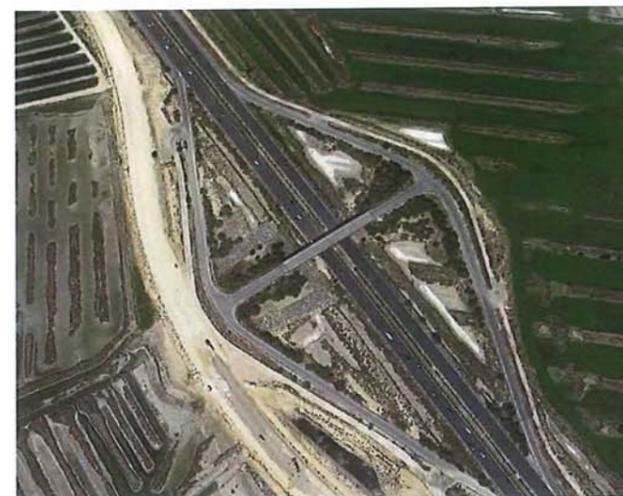
Se puede apreciar los escasos radios de giro en las intersecciones de los ramales con el paso superior en sí (radios de apenas 15 metros).
