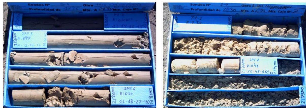
Aspecto a visu del nivel Terciario TA (testigo S-4) / secuencia de arenas arcillosas y arenas limosas. Compacidad Densa - Muy Densa
