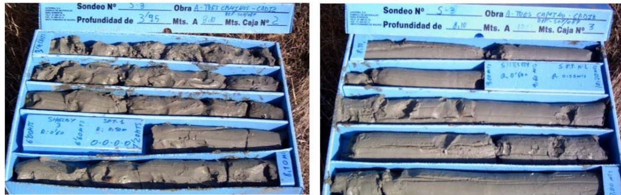
Aspecto a visu del nivel de Marisma QM (testigo S-3) / secuencia de arcillas CL - CH de Consistencia Muy Blanda
